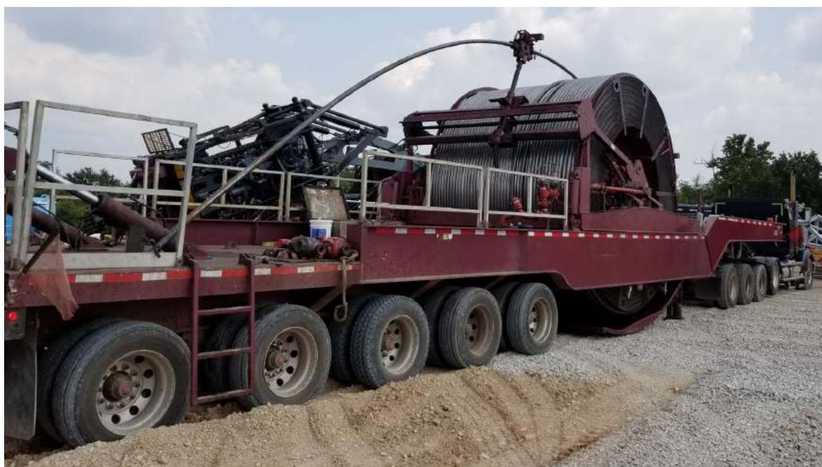
Abbildung 2: Montage der Coil-Tubing-Anlage auf Standort des Bohrlochs Jewell in Carter County, Oklahoma
